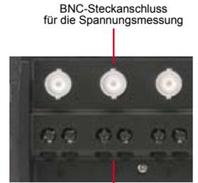
BNC-Steckanschluss für die Spannungsmessung
